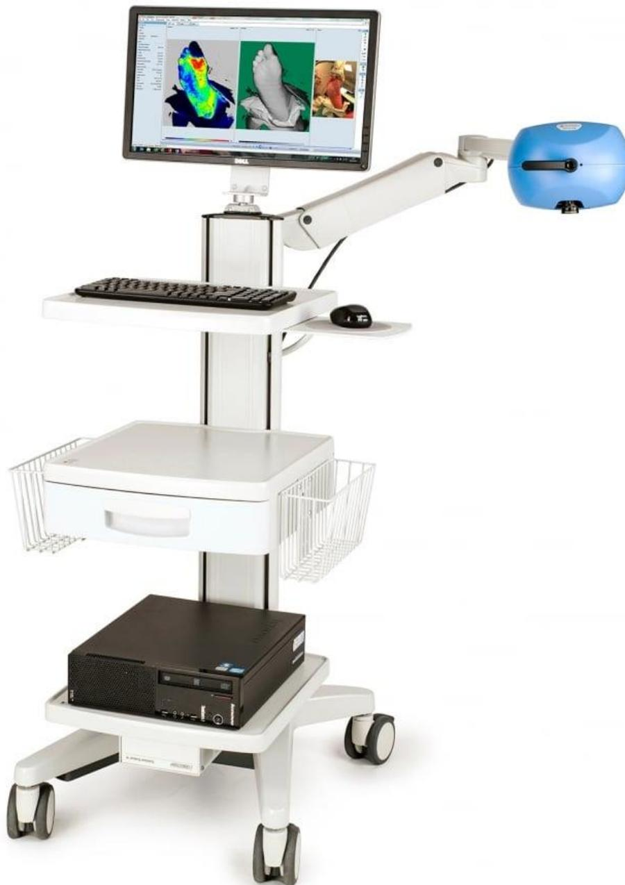
**Abbildung 8: Darstellung des PeriCam PSI NR Systems (Normal Resolution).** Im Einzelnen besteht das Gerät aus einem Desktop-Computer, zudem beinhaltet es den Scannerkopf, welcher die Maße 22x15x20cm aufweist und 2,4 kg schwer ist (Abb. nach "PeriCam PSI System - a blood perfusion imager based on LASCA," n.d.).
