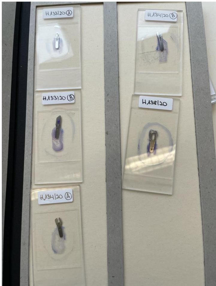
Abbildung 9 Schliffpräparat mit Toluidinblau gefärbt.
