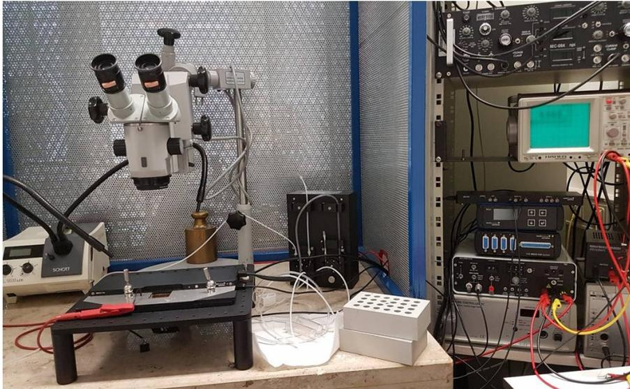
**Abbildung 18: Das Microelectrode Array System Setup**
