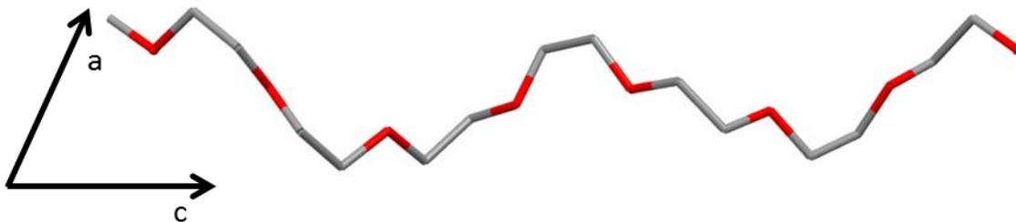
**Abb. 90:** Schematische Darstellung einer PEG-Kette in  $7_2$  Helix-Konformation.
