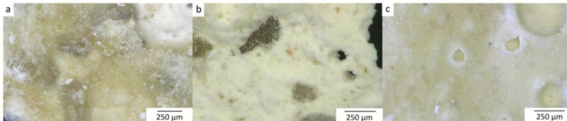
Abb. 6-6: Mikroskopische Aufnahmen von Putzoberflächen. a) Probe aus Joch 5, 2.1 m, entnommen im September 2016; b) Probe aus Joch 12, 2.0 m, entnommen im Juni 2016; c) Probe aus Joch 1, 1.6 m, entnommen im Februar 2017.
