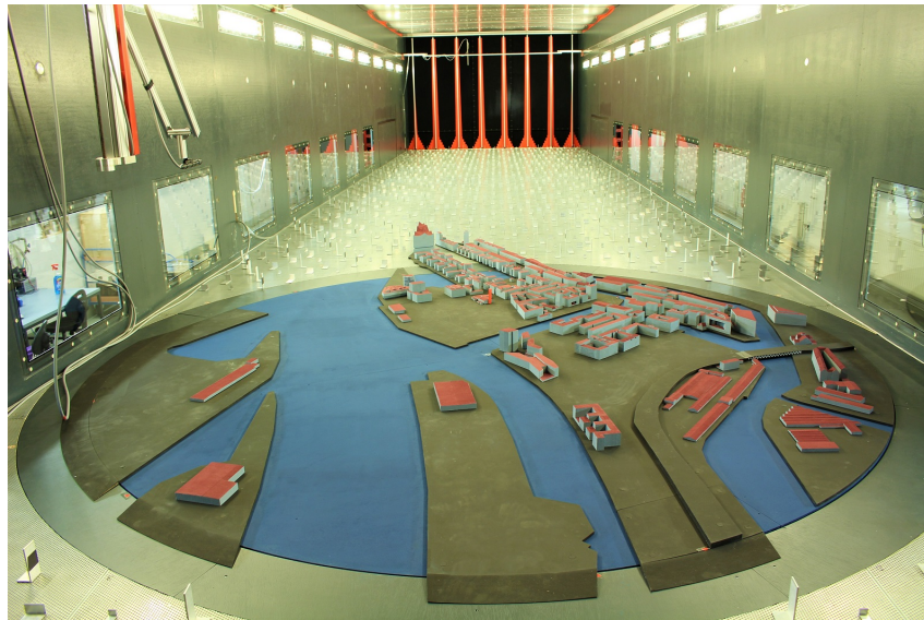
Abbildung 5.1.: Windkanalmodell der HafenCity Hamburg (Bebauungszustand von 2017)
