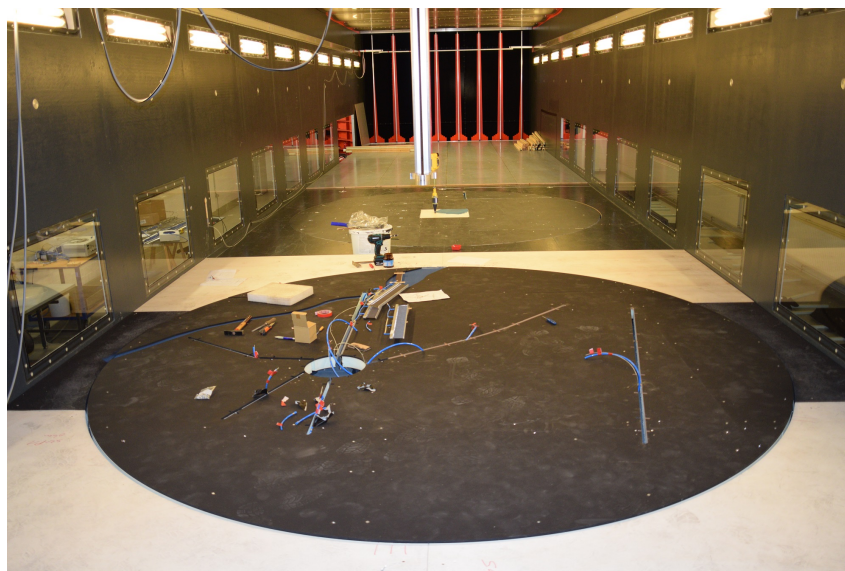
Abbildung 6.1.: Einbau der Linienquellen in das Ernst-Reuter-Platz-Modell
