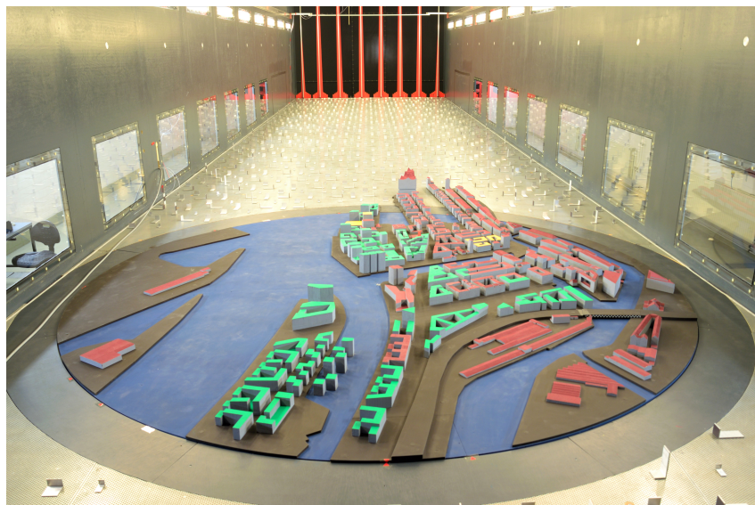
Abbildung 5.2.: Windkanalmodell der HafenCity Hamburg (geplanter Bebauungszustand von 2023)
