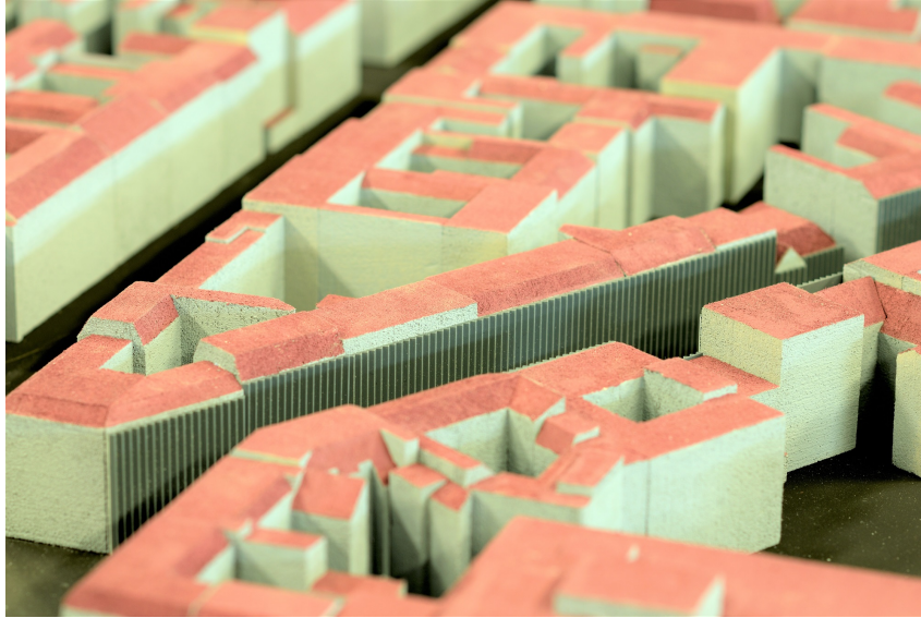
Abbildung 5.4.: Ausschnitt aus dem ersten Berlin-Modell mit zusätzlicher Wandrauigkeit
