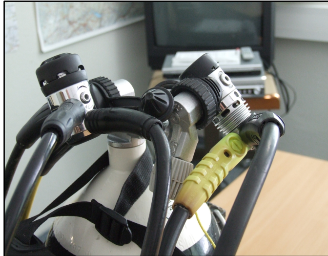
Abb. 34 re und li: ungünstige Montagekonfiguration des Zweitatemreglers. Beide 2. Stufen des Zweitatemreglers waren ohne korrigierende Drehung um 180° nicht einsatzbereit
