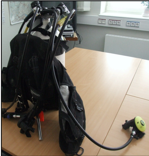
Abb. 34 re und li: ungünstige Montagekonfiguration des Zweitatemreglers. Beide 2. Stufen des Zweitatemreglers waren ohne korrigierende Drehung um 180° nicht einsatzbereit
