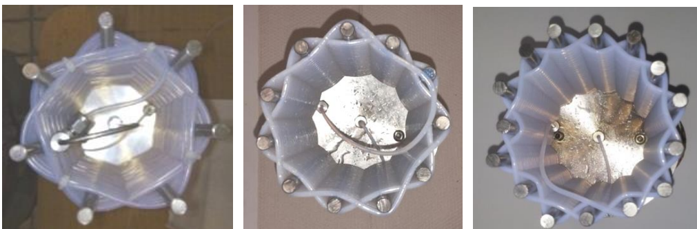
Abbildung 5.3: Draufsicht auf den alternierend gewickelten Rohrreaktor mit 7 [2, 3] , 11 und 15 Stangen.
