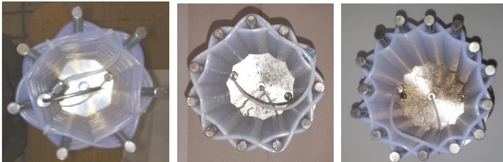
Abbildung 6.26: Draufsicht auf den alternierend gewickelten Rohrreaktor um 7, 11 und 15 Stangen.
