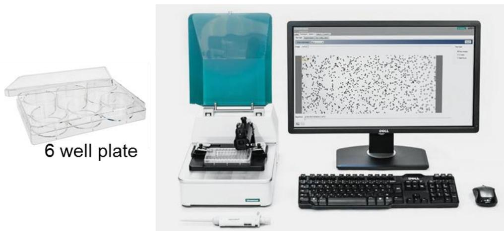
**Abbildung 28:** 6 well plate für die SAP-Probenverarbeitung (links) und das oCelloScope von Philips (rechts) für die Messung.
