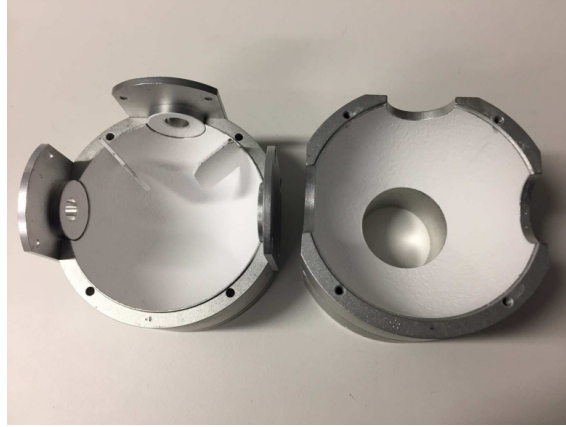
Abbildung A.9.: Die verwendete Ulbrichtkugel von Innen. Zu sehen sind die obere Halbkugel (links) und die untere Halbkugel (rechts) mit ihrer stark reflektierenden Beschichtung.
